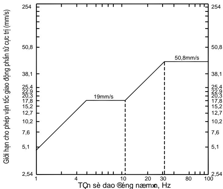
2. Việc đo chấn động phải thực hiện ở công trình gần nhất với vị trí nổ mìn. Điểm đặt, số lượng điểm đo, phương pháp đặt thiết bị đo thực hiện theo TCVN 7197:2002 và theo hướng dẫn của nhà chế tạo. Điểm đặt cho kết quả tin cậy là các điểm đặt bên trong công trình có bề mặt đối diện với khu vực nổ mìn.
